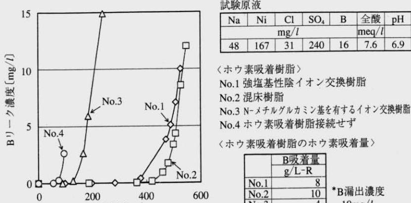
図6 ホウ素を含む排水の循環試験結果
