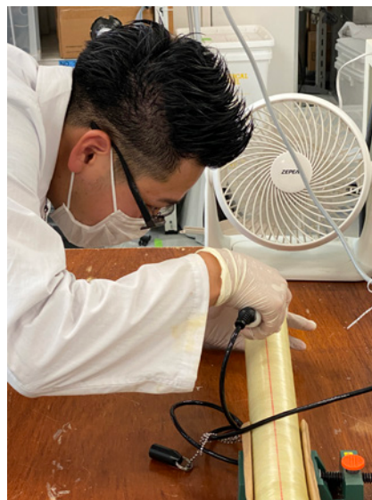
使用済みRO膜のアップサイクルに向けてRO膜を解体中（サーキュラーエコノミー）
