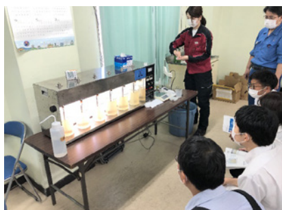
実習2 凝集試験(ジャーテスト)
