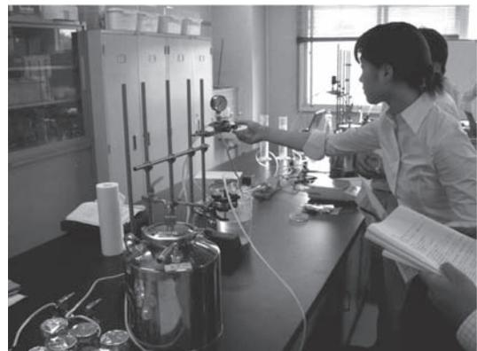
定圧濾過試験 試験風景
